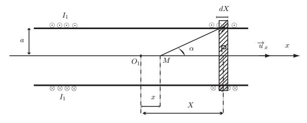
Le champ magnétique crée par une spire en tout point M de son axe :  $\vec{b}(M) = \frac{\mu_o I_1}{2a} \sin^3 \alpha \vec{u}_x$ Le champ magnétique élémentaire crée par une tranche d'épaisseur dX vaut , en M :
