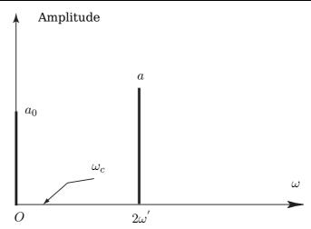
**3.1.4**. La fréquence de coupure  $\omega_c$  du filtre est très inférieur à  $\omega'$ : les composantes variables de fréquences  $2\omega'$  sont, donc, atténuées et le filtre (d'amplification A) ne laisse passer que les composantes continues. Soit :
